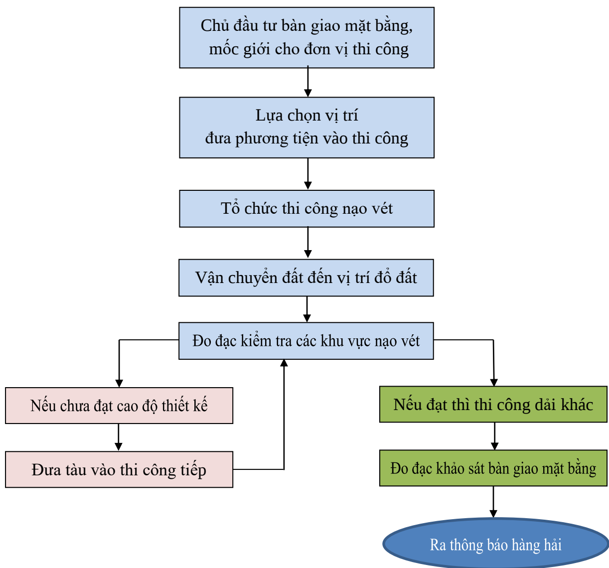
Hình 2. Trình tự thi công
